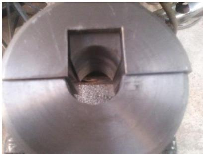
Para el ensamble del chuck fue necesario emplear una barra de 1" de diámetro para el centrado de los componentes, evitando con ello el desbalanceo de las mismas al momento de ser soldadas ver figura 3.17.
